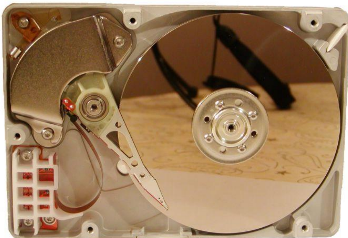
Vnútro pevného disku (hlavy a platne pevného disku)
