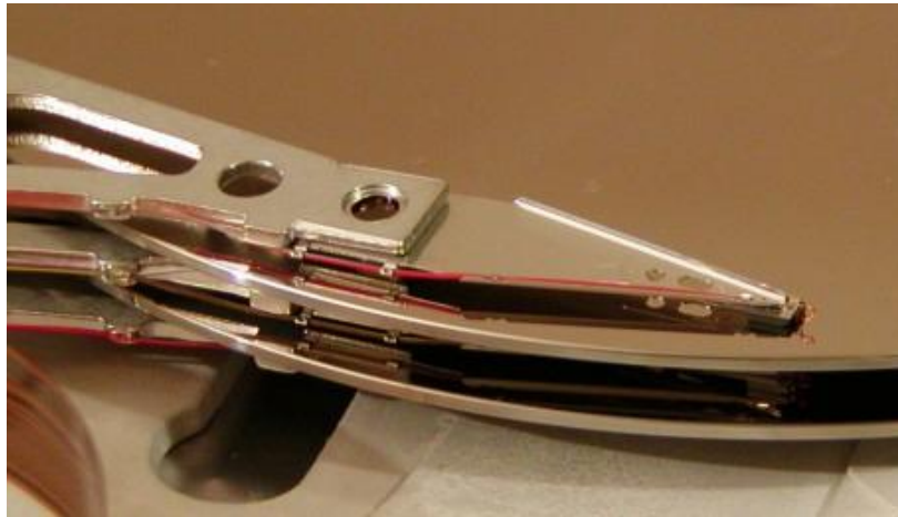
Detailný pohľad na ramená disku s čítacími a zapisovacími hlavami.
